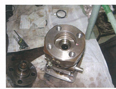
噴燃ポンプ分解整備
